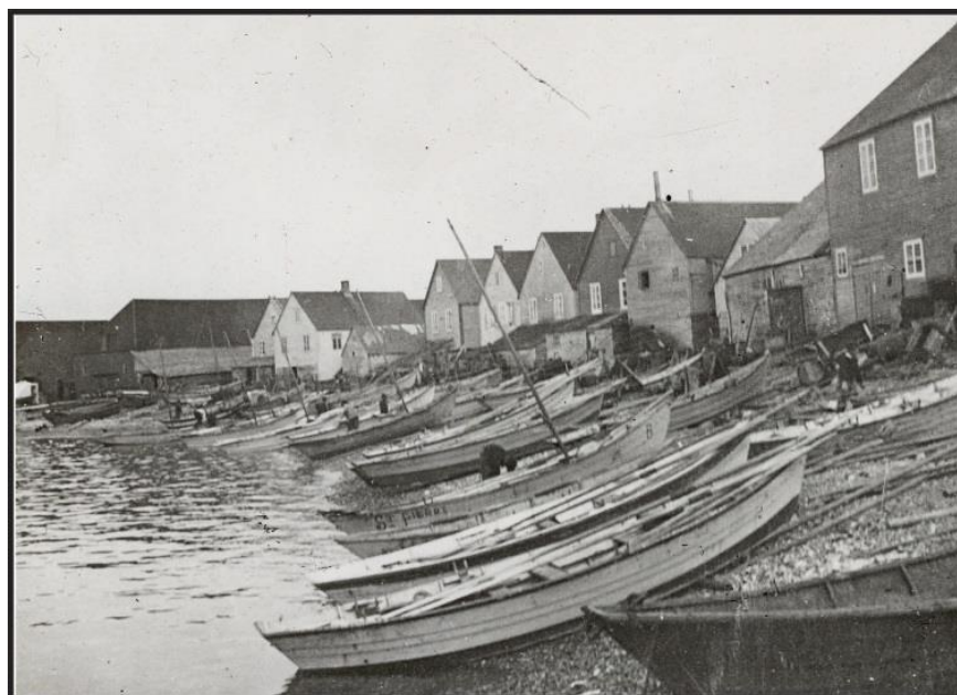
Figura 82 – Embarcação típica da região de Quebec no Canadá, denominada Dóri. (foto: https://ehne.fr/sites/default/files/fondcolbert/18192_0.jpg )
