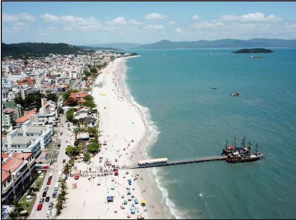
Figura 71. Vista do engordamento de praia por alimentação artificial de sedimentos (#24) localizado na praia de Canasvieiras, no município de Florianópolis. Em primeiro plano pode ser observada a estrutura de um píer (#23).
