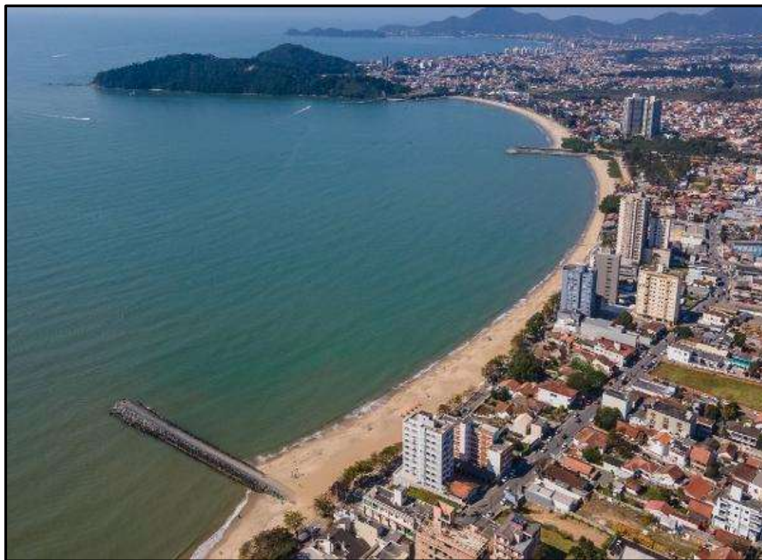
Figura 94. Vista para sul da praia de Piçarras Penha, localizada no município de Balneário Piçarras, observando-se a estrutura de engordamento entre dois espigões.
