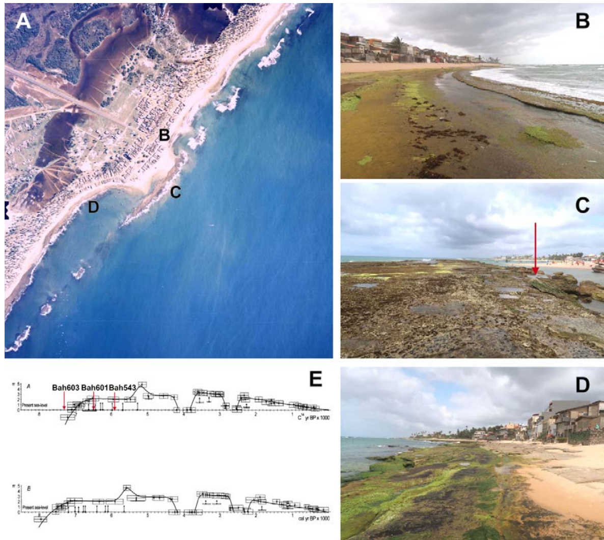
Figura 9 – Parada 2. A – Fotografia aérea vertical da localidade de Arembepe, mostrando as duas ocorrências de arenito discutidas no texto. As letras indicam a localização das fotos apresentadas nas figuras 9B (Ocorrência 2), 9C (Ocorrência 1) e 9D (Ocorrência 2). A seta vermelha na figura 9C indica um bloco de arenito revirado. E – Curva de variação do nível relativo do mar para Salvador-Bahia, respectivamente não calibrada (superior) e calibrada (inferior) (Martin et al. 2003). As setas vermelhas indicam as idades radiocarbono obtidas para amostras de conchas coletadas nestes arenitos e descritas no texto. Ver figura 1 para localização da parada.
